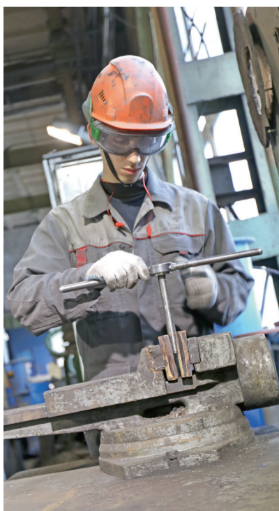
Алексей Евлахов устанавливает шпильку в тисках.
